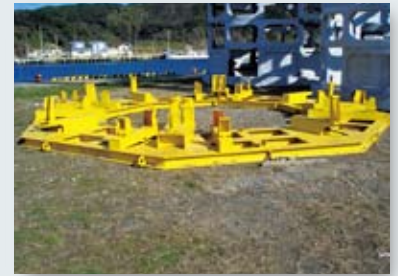
下端リング組立専用足場
